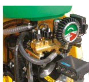
Električna kontrola za Synthesis sa 2 mesingana električna ventila, za distribuciju hemijskog sredstva za levu/desnu stranu. Manuelna regulacija pritiska. Komplet je opremljen samočistećim filterom od nerđajućeg čelika i manometrom Ø100 mm.
