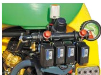
Komplet motornih elektro ventila "Compact Plus" 2 + 2 za Synthesis sa 2 nezavisna motorna ventila za otvaranje/zatvaranje (desno / levo), plus 1 motorizovani ventil za regulaciju pritiska, a drugi za operaciju/rasterecanje (On-Off) pumpe (BY-PASS), filter, manometar Ø100 mm.
